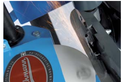
Exzentrerspanneinrichtung an den Kufen
