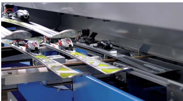
Automatische Beladung mit exakter Zentrierung des Skis
