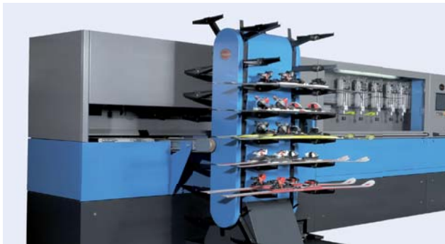
Zuführung von jeweils bis zu 24 Ski über den integrierten Paternoster
