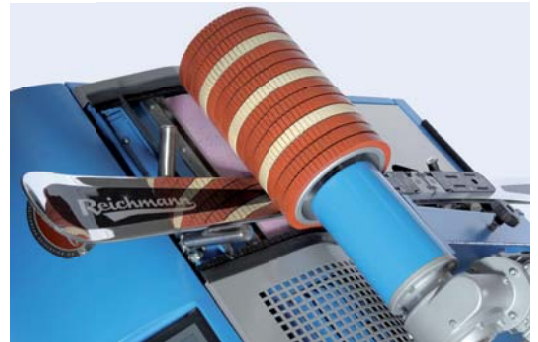
Exakter Steinstrukturschliff über die gesamte Skilänge
