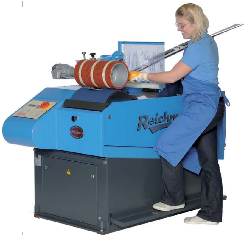
Komfortabler Wechsel von Stein auf Band über die pneumatische Abhebevorrichtung
